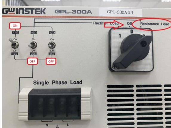
圖 4.14 GPL-300A 設定圖 (42ohm)
