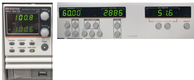
圖 3.22 滿載下 PSW 與 APS-300 的功率狀態
