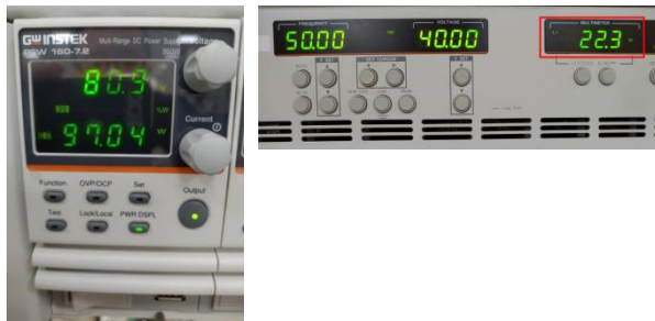
圖 5.18 滿載下 PSW 與 APS-300 的功率狀態
