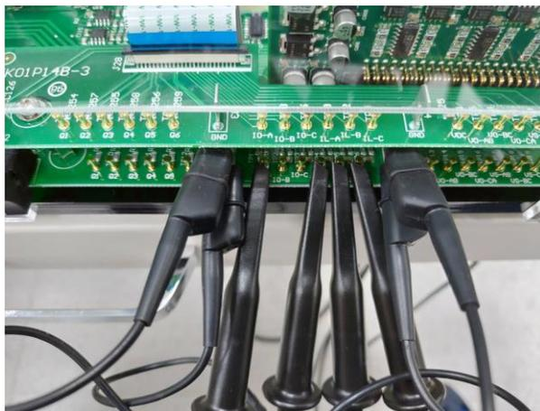
如圖 2.20 所示，於不平衡載時，觀測 IL-A、IL-B 與 IL-C 之 RMS 值分別為 0.835A(實際值為 1.751A)、1.26A(實際值為 2.643A)、1.25V(實際值為 2.622A)，可發現負載電流為不平衡狀態。
