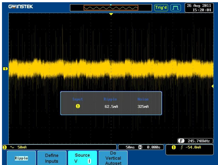
圖8: GDS-3000 Ripple/Noise 量測結果示意圖
